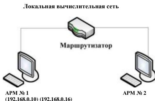
Рис. 2. Схема макета сегмента вычислительной сети, имитирующего передачу данных через незащищённый канал
