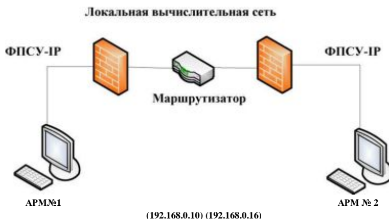
Рис. 3. Схема макета сегмента вычислительной сети, имитирующего передачу данных через защищенный канал
